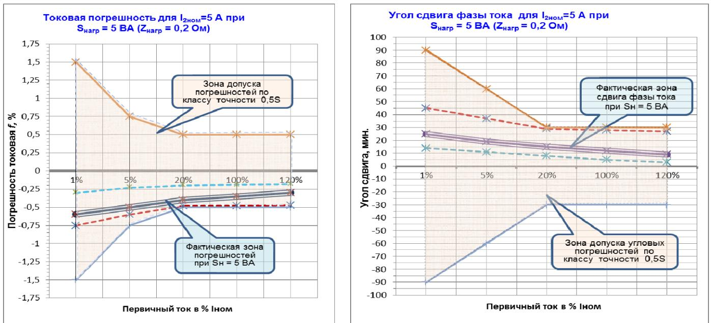
Рисунок Б.4 Похибка при коефіцієнті трансформації 300/5 А
